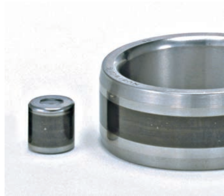
图 4-2 普通轴承上发生的电蚀(坑)
